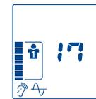
Następuje automatyczne pompowanie powietrza. Trzy krótkie dźwięki oznaczają, że zostało osiągnięte niezbędne ciśnienie pompowania i rozpoczyna się pomiar. Pomiar postępuje w trakcie wypuszczania powietrza.
