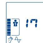
Непосредствено след това започва автоматичното напompване. Три кратки сигнални тона показват, че необходимото налягане е достигнато и измерването започва. Процесът на измерване започва с изпускането на въздуха.
